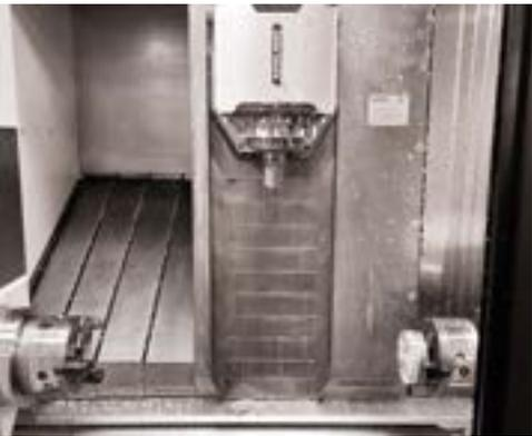
Spindeleinheit zur axialen und radialen Bearbeitung.
