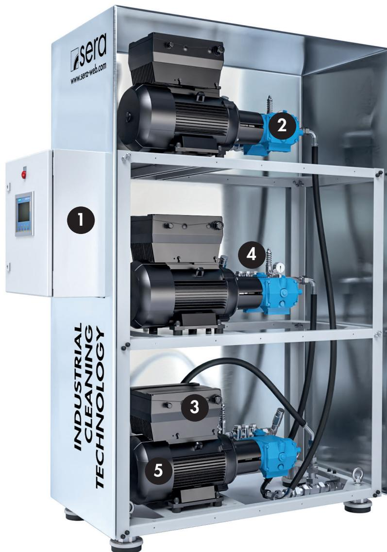
Das Komplettsystem von **sera** ist für den industriellen Dauereinsatz von mehreren Handlanzen, Tankwaschköpfen oder anderen Verbrauchern im Hochdruckbereich bis zu 250 bar geeignet.
