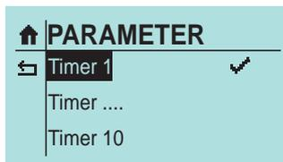
Le timer permet de doser une charge au cours duquel une charge débute à un moment défini, ou permet d'allumer et d'éteindre la pompe en fonction du temps.
