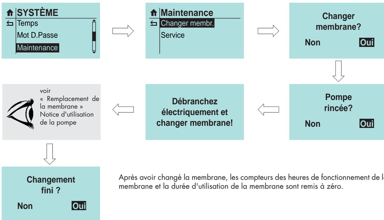
Après avoir changé la membrane, les compteurs des heures de fonctionnement de la membrane et la durée d'utilisation de la membrane sont remis à zéro.
