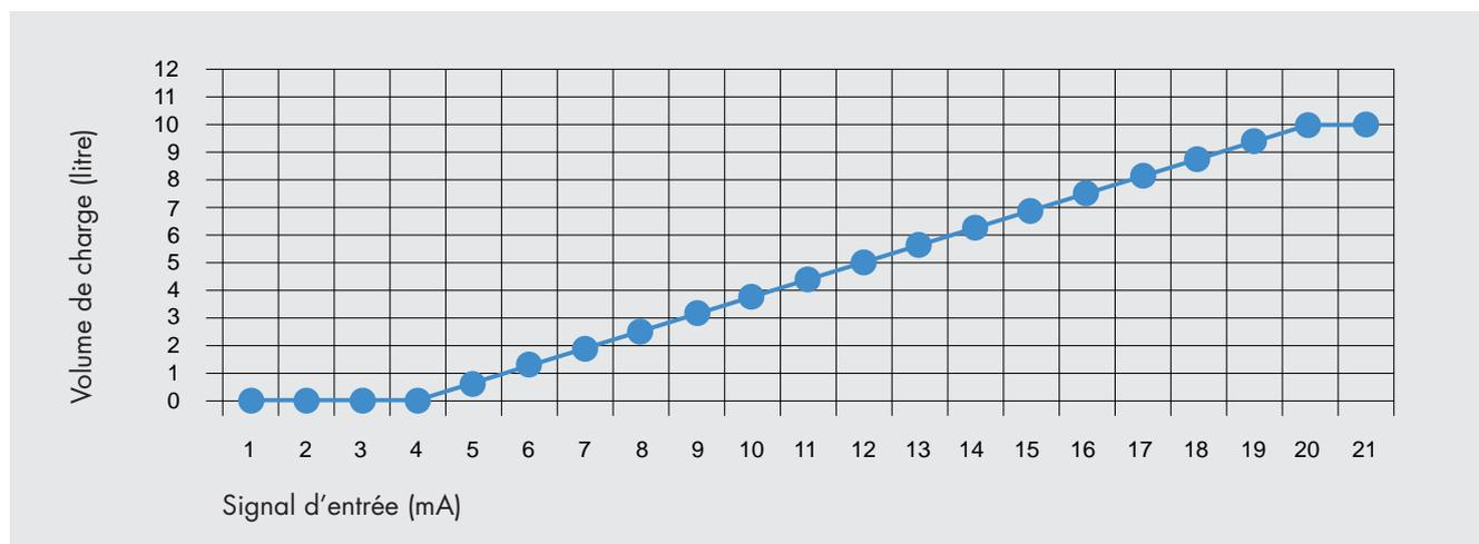
Pour le réglage de la vitesse de pompage, il se comporte de la même manière que lors du réglage du volume de charge. La valeur maximale, qui correspond au signal de 20mA, est sélectionnée. Un signal d'entrée correspondant situé entre 4mA et 20mA permet de régler le débit.
