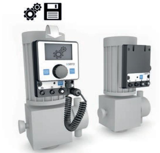
Das Display kann nun von der Pumpe abgeschraubt werden und mit einer anderen Pumpe verbunden werden. Mit Datentransfer „Display-Pumpe“ können die auf dem Display gespeicherten Parameter auf die zweite Pumpe übertragen werden. Dieser Vorgang kann beliebig oft mit weiteren Pumpen wiederholt werden. Nach dem Datentransfer die Pumpe(n) neu kalibrieren. Der Vorteil ist, dass nicht jede Pumpe einzeln parametrierbar werden muss.
